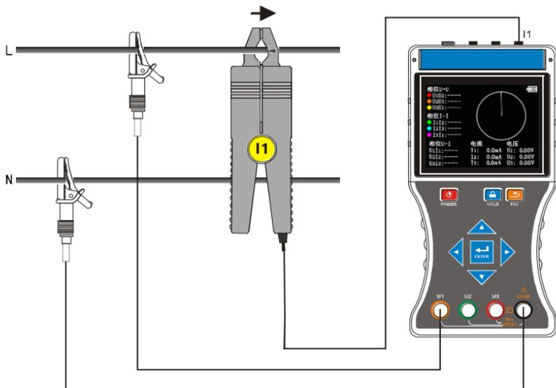
测试三相四线电压、电流、相位、相序、频率、功率、功率因数等：
