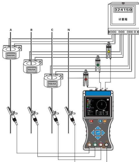
测试三相三线电压、电流、相位、相序、频率、功率、功率因数等：
